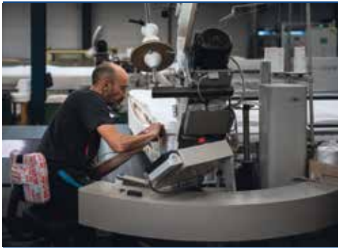
Si 500 000 € ont déjà été investis, notamment dans les machines, la main d'œuvre reste au cœur de l'usine. Ici, un ouvrier réalise la fermeture du matelas, étape minutieuse de couture.
